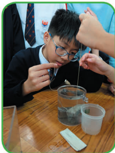
我們嘗試用排水法量度不規則立體的體積。
